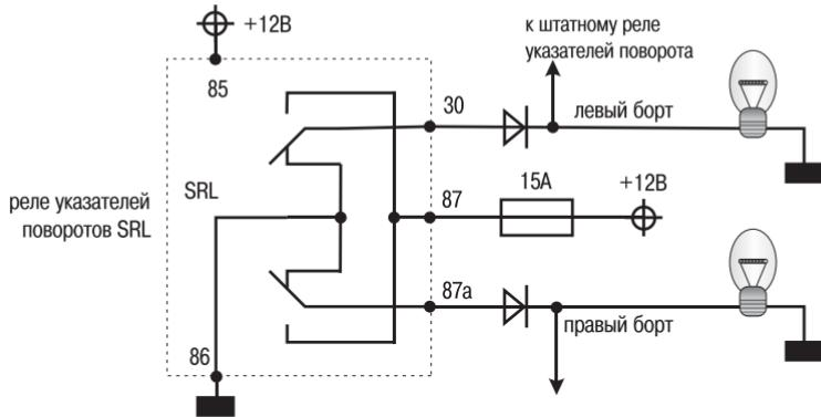
Предназначено для управления указателями поворота. Питание +12В на указатели должно подключаться через предохранитель.
