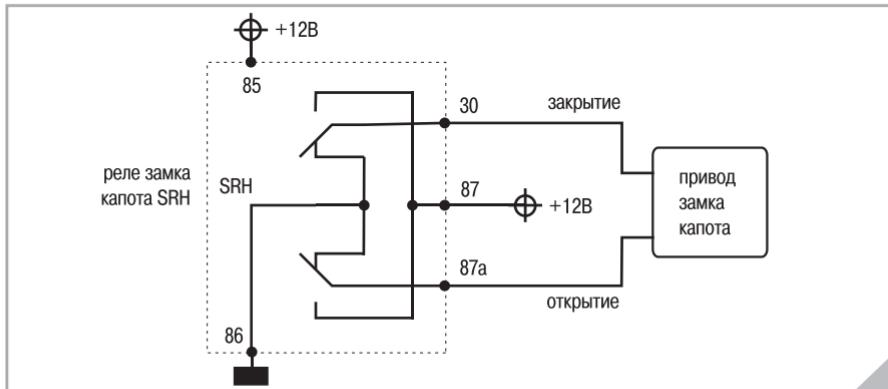
Предназначено для управления электроприводом замка капота в системах без сирены Magic Voice. Длительность импульсов можно изменить с помощью программы Magic Tuner. Команда закрытия замка капота подается при постановке в охрану, если выключено зажигание и капот закрыт. Команда открытия замка капота подается при снятии с охраны, если ранее замок капота был закрыт.
