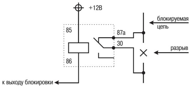
При активной блокировке<sup>1</sup> разрываемая цепь подключается к нормально замкнутым контактам реле. Двигатель блокируется (контакты реле размыкаются, разрывая цепь) при включении зажигания в режиме *тревога*.
