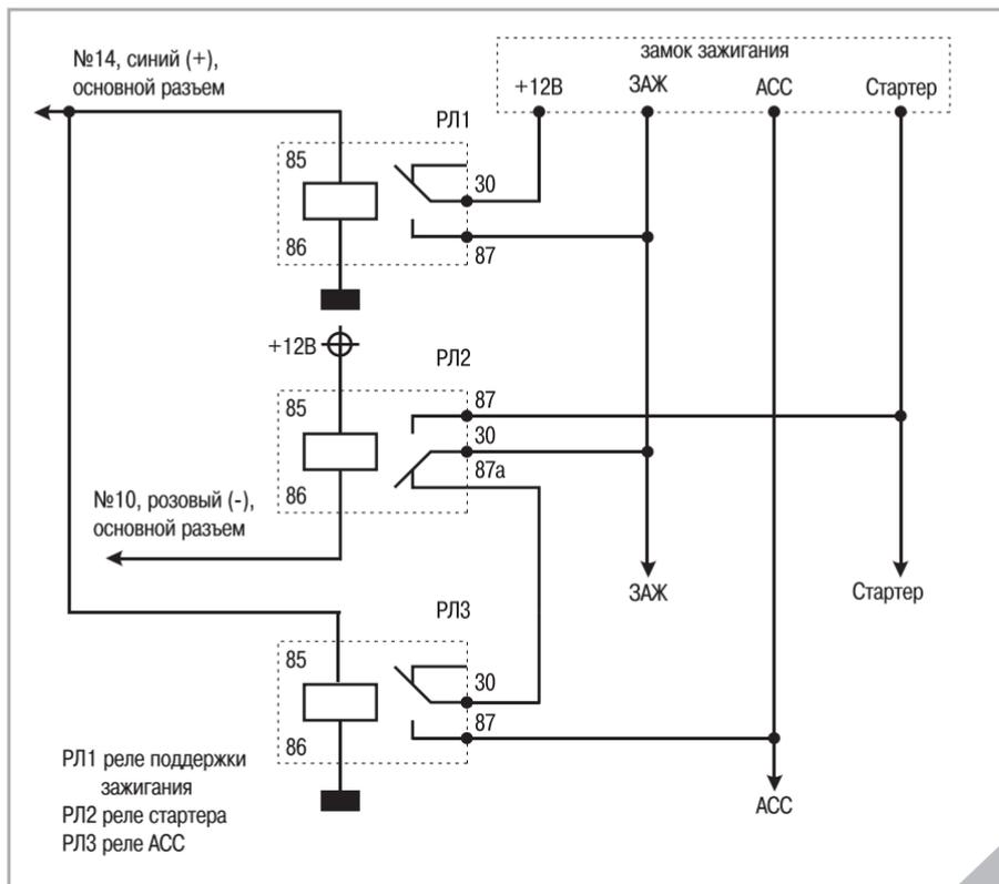
Такая схема подает питание на аксессуары (положение АСС замка зажигания), если двигатель заведен при помощи дистанционного запуска. Во время работы стартера питание не подается.
