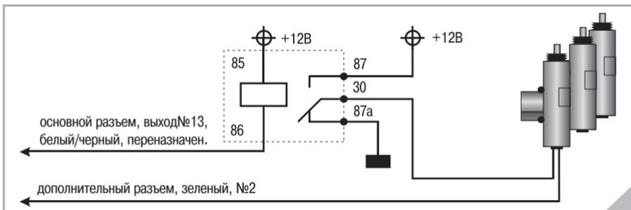
Если в автомобиле есть встроенная функция «комфорт» и выход на стеклоподъемники не нужен, переназначьте его на управление американским замком.
