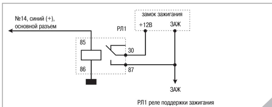
Если выполнено подключение дистанционного запуска, то никаких дополнительных подсоединений не требуется. Если дистанционный запуск двигателя не подключен, но требуется режим турбо-таймера, то необходимо подключить выход на поддержку зажигания и вход датчика положения ПАРК (или «ручника»).
