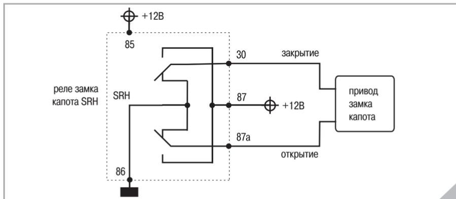
Предназначено для управления электроприводом замка капота в системах без sireны Magic Voice. Длительность импульсов можно изменить с помощью программы Magic Tuner. Команда закрытия замка капота подается при постановке в охрану, если выключено зажигание и капот закрыт. Команда открытия замка капота подается при снятии с охраны, если ранее замок капота был закрыт.
