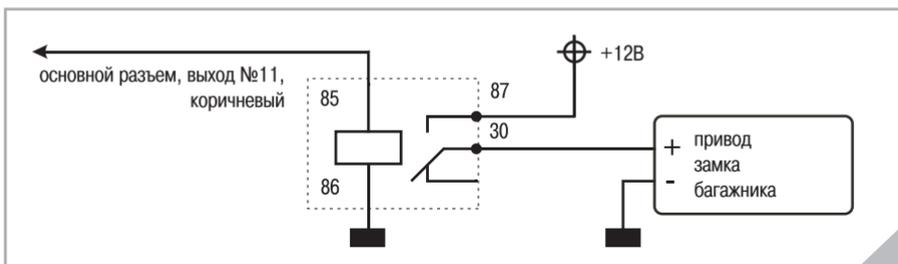
Подключение электрического замка багажника позволяет отпирать багажник, не пользуясь ключами, по команде с брелка. Если автомобиль не имеет электропривода замка багажника, его придется установить дополнительно.
