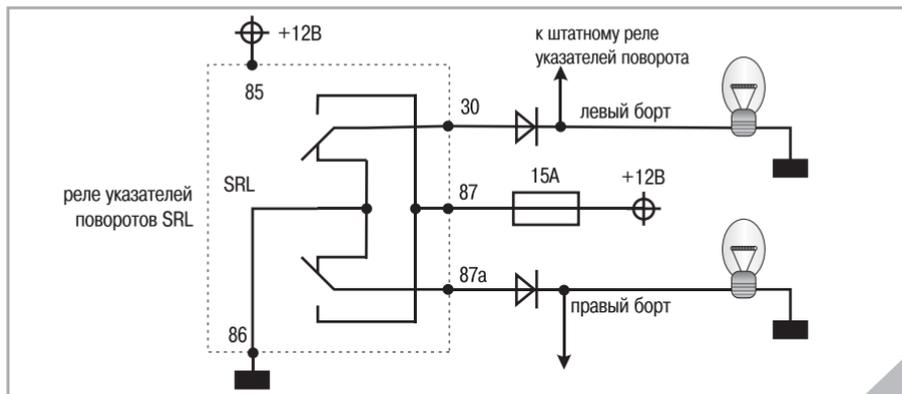
Предназначено для управления указателями поворота. Питание +12В на указатели должно подключаться через предохранитель.
