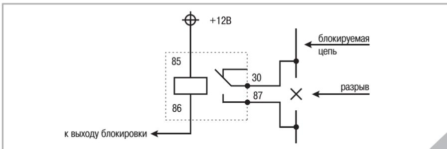
При пассивной блокировке (заводская установка) разрываемая цепь подключается к нормально разомкнутым контактам реле. Блокировка снимается (контакты реле замыкаются, восстанавливая разорванную цепь) при включении зажигания в режиме *снято с охраны*.
