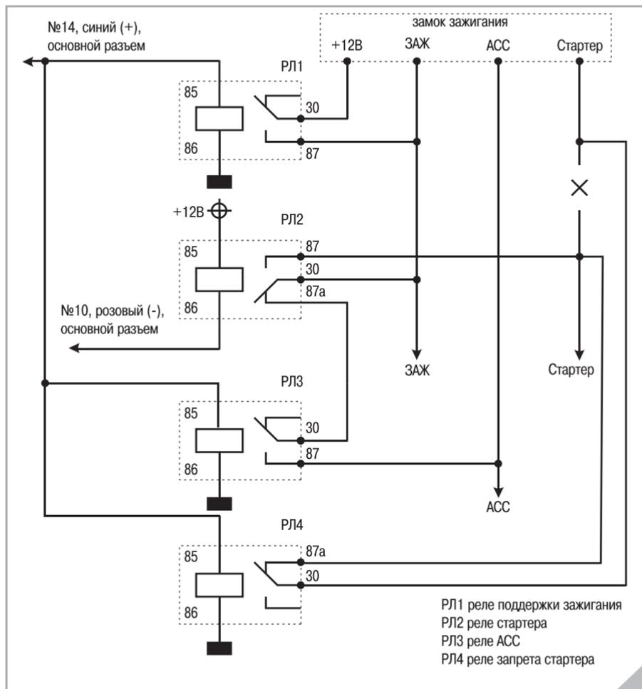
В такой схеме подключения, кроме питания аксессуаров, обеспечивается защита от случайного включения стартера, если двигатель заведен при помощи дистанционного запуска.
