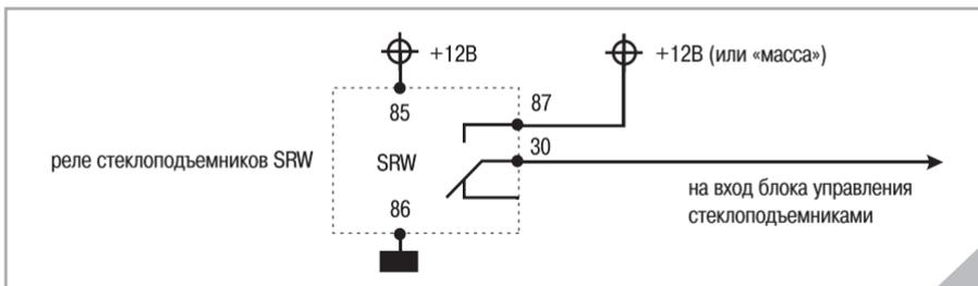
Предназначено для управления модулем стеклоподъемников. Система подает команду закрытия стекол при постановке на охрану, после закрытия замков дверей.
