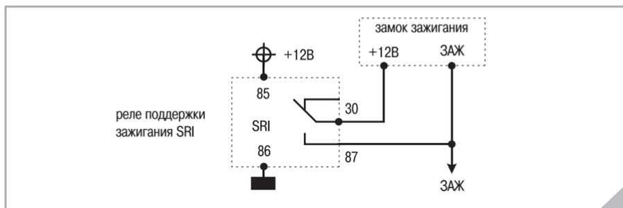
Предназначено для включения поддержки зажигания, если нет необходимости в дистанционном запуске, например, для обеспечения режима турбо-таймера.
