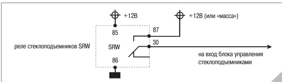
**Автоматического режима нет.** Потребуется блок управления стеклоподъемниками, обеспечивающий отключение их двигателей при достижении крайних положений.
