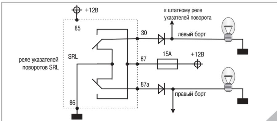
Предназначено для управления указателями поворота. Питание +12В на указатели должно подключаться через предохранитель.
