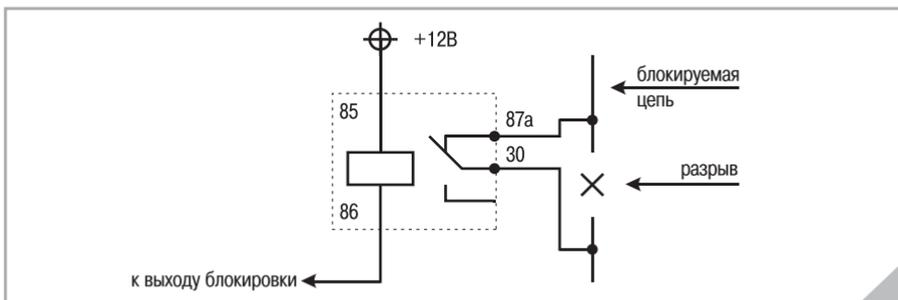
При активной блокировке<sup>1</sup> разрываемая цепь подключается к нормально замкнутым контактам реле. Двигатель блокируется (контакты реле размыкаются, разрывая цепь) при включении зажигания в режиме *тревога*.
