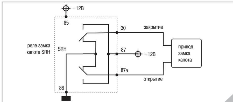
Предназначено для управления электроприводом замка капота в системах без сирены Magic Voice. Длительность импульсов (по умолчанию 0,8 сек.) можно изменить с помощью программы Magic Tuner. Команда закрытия замка капота подается при постановке в охрану, если выключено зажигание и капот закрыт. Команда открытия замка капота подается при снятии с охраны, если ранее замок капота был закрыт.
