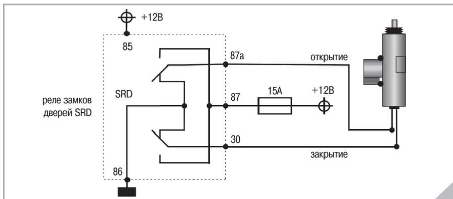
Предназначено для управления приводами замков дверей. Питание +12В приводов замков должно подключаться через предохранитель.
