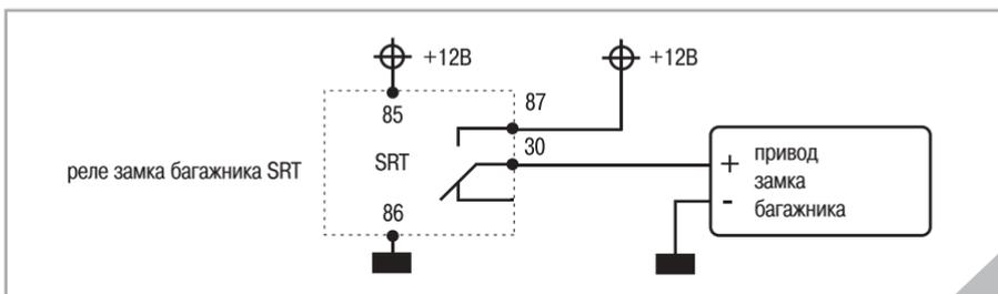
Предназначено для управления электрическим замком багажника. Длительность импульса программируется с помощью программы Magic Tuner. Команда открытия багажника подается с брелка или метки.
