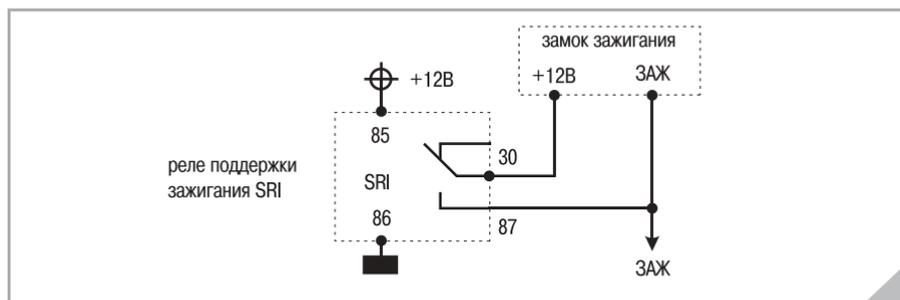
Турбо-таймер (т.е. реле поддержки зажигания) включается на 30 секунд<sup>2</sup>, если перевести АКПП в положение ПАРК (вытянуть «ручник») при работающем двигателе.
