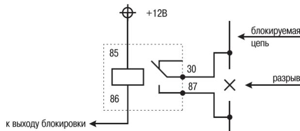
При пассивной блокировке (заводская установка) разрываемая цепь подключается к нормально разомкнутым контактам реле. Блокировка снимается (контакты реле замыкаются, восстанавливая разорванную цепь) при включении зажигания в режиме *снято с охраны*.
