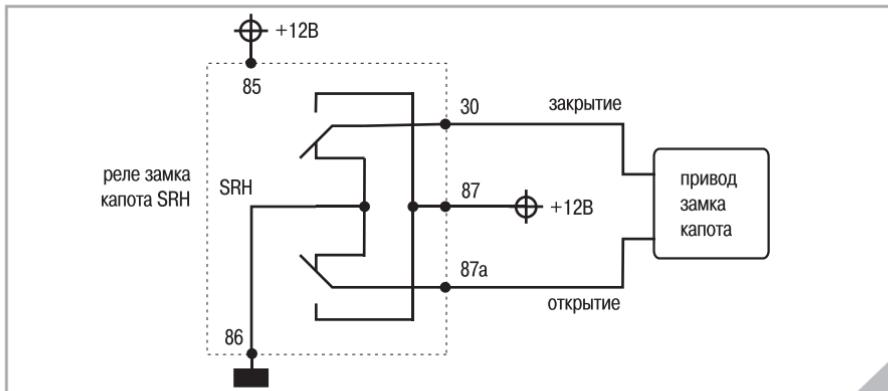
Предназначено для управления электроприводом замка капота в системах без сирены Magic Voice. Длительность импульсов (по умолчанию 0,8 сек.) можно изменить с помощью программы Magic Tuner. Команда закрытия замка капота подается при постановке в охрану, если выключено зажигание и капот закрыт. Команда открытия замка капота подается при снятии с охраны, если ранее замок капота был закрыт.
