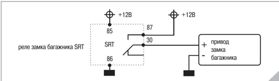
Предназначено для управления электрическим замком багажника. Длительность импульса программируется с помощью программы Magic Tuner. Команда открытия багажника подается с брелка или метки.
