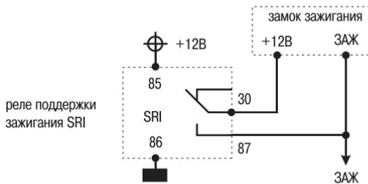
Турбо-таймер (т.е. реле поддержки зажигания) включается на 30 секунд<sup>2</sup>, если перевести АКПП в положение ПАРК (вытянуть «ручник») при работающем двигателе.
