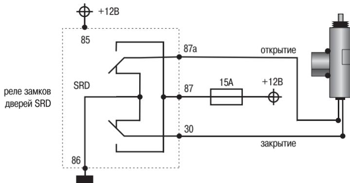
Предназначено для управления приводами замков дверей. Питание +12В приводов замков должно подключаться через предохранитель.
