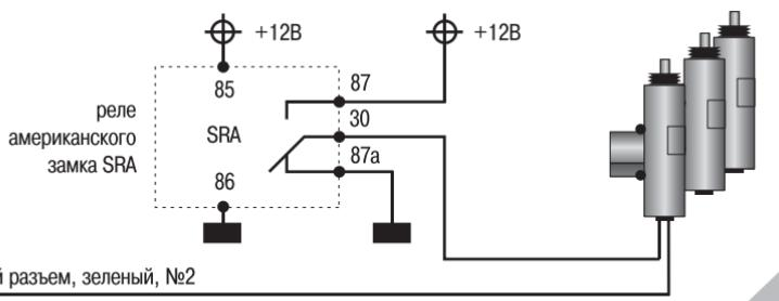
Предназначено для управления приводами замков дверей пассажиров при подключении американского центрального замка. Приводы дверей пассажиров подключаются по приведенной схеме, дверь водителя - как обычно.
