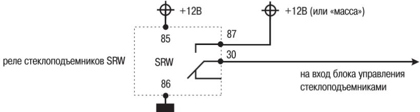
Предназначено для управления модулем стеклоподъемников. Система подает команду закрытия стекол при постановке на охрану, после закрытия замков дверей.
