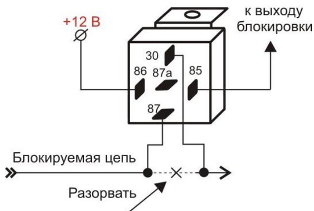
При активной блокировке разрываемая цепь подключается к нормально замкнутым контактам реле. Двигатель блокируется (контакты реле размыкаются, разрывая цепь) при включении зажигания, если работа двигателя запрещена.
