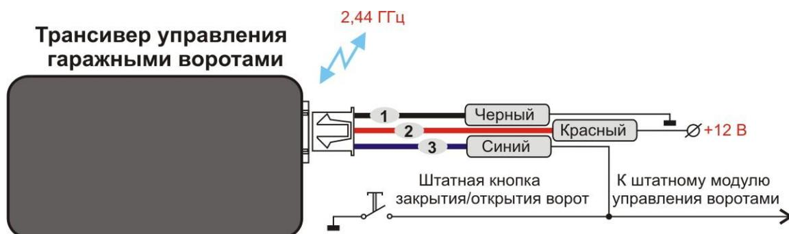
Для питания трансивера следует использовать адаптер с выходным током не менее 300 мА. Синий провод трехжильного кабеля трансивера подключается к штатной кнопке открытия/закрытия ворот. При получении команды на открытие или закрытие ворот, трансивер выдает сигнал отрицательной полярности на синий провод, имитируя замыкание штатной кнопки на массу. Максимальный выходной ток составляет 100 мА.
